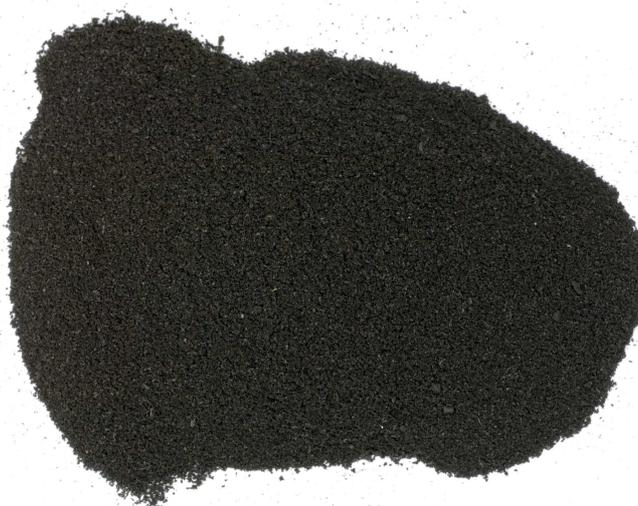
En esta línea, la utilización de polvo de caucho, incorporado a una mezcla bituminosa por cualquiera de las dos vías posibles (vía seca y vía húmeda), es adecuada y mejorará el comportamiento de la misma y del firme que forme parte.
